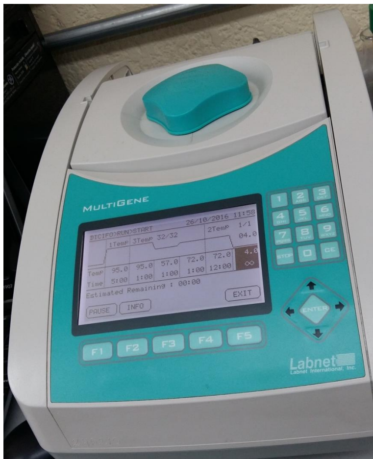
Ilustración 3. Programa para amplificación de ADN mediante PCR en muestras de Fusarium y Trichoderma en termociclador de punto final.
